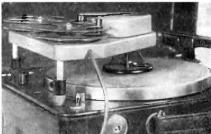
Фиг. 10. Установка лентопротяжного механизма на диске электропроигрывателя.
