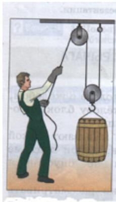
Рис. 181. Комбинация подвижных и неподвижных блоков — полиспаст» [1, с. 182].
