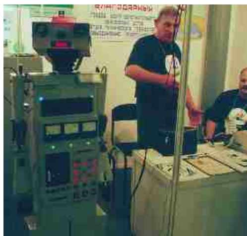
Робот видеонаблюдения. Управляется при помощи компьютера. Оснащен различными устройствами, например сенсорами, регулирующими силу сжатия манипуляторов.
