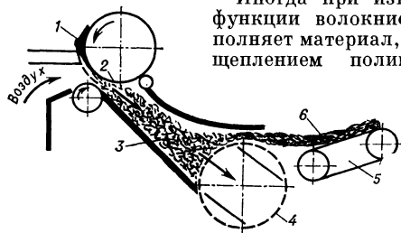
Рис. 2. Схема устройства для получения холста аэродинамическим методом: 1 — волоконная машина, 2 — съемный барабан чесальной машины, 3 — диффузор, 4 — конденсор, 5 — выводной транспортер, 6 — сформированный холст.
