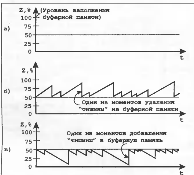
Рис. 3. Временные диаграммы заполнения буферной памяти: а — идеальная ситуация; б — темп пополнения буфера выше темпа его рассасывания; в — темп пополнения буфера ниже темпа его рассасывания
