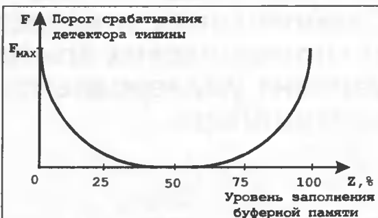
Рис. 4. Зависимость порога срабатывания детектора тишины от уровня заполнения буферной памяти
