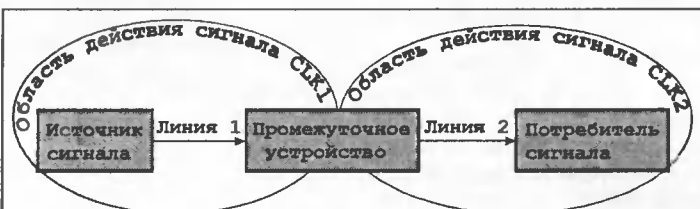
Рис. 5. Система передачи данных с двумя доменами синхросигналов
