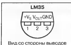
Рис. 1. Цоколевка датчика температуры LM35
