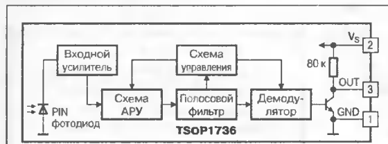
Рис. 3. Структурная схема приемника TSOP1736
