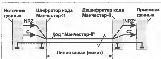
Рис. 23. Упрощенный пример построения канала связи для передачи данных в коде «Манчестер-II» (рассмотрено одно направление передачи)
