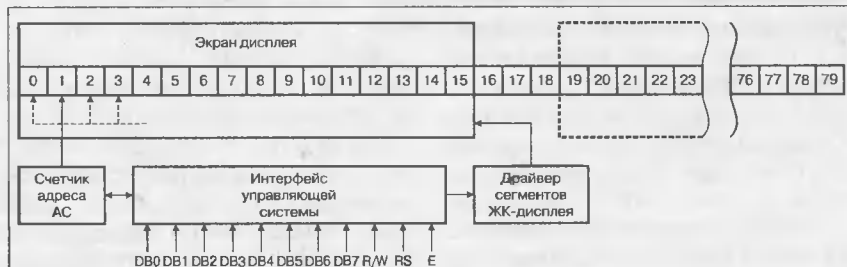
Рис. 31. Упрощенная внутренняя структура индикатора DV-16100
