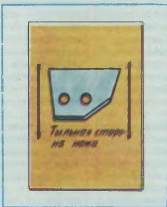
Рис. 2. Направление движения ножа при заточке.
