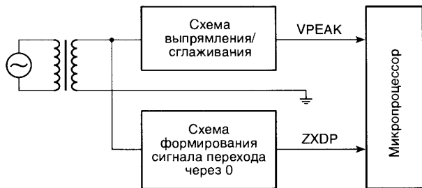
Рис. 3. Блок-схема управления питанием нагревателя
