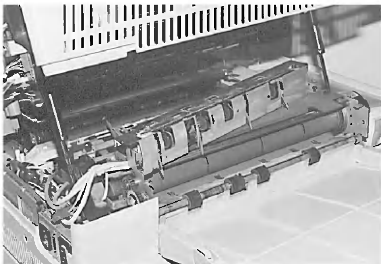
Рис. 4. Внешний вид открытого аппарата со стороны блока фьюзера
