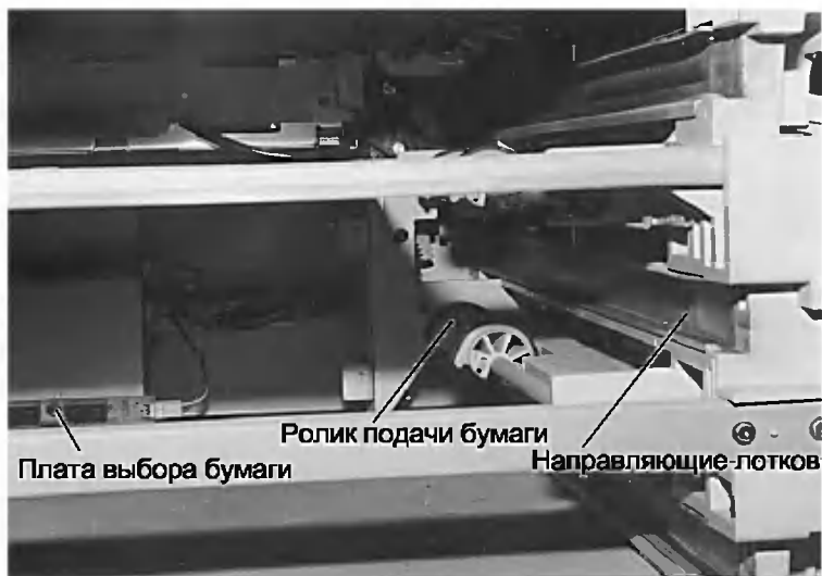
Рис. 3. Внешний вид аппарата с вытасценными лотками подачи бумаги
