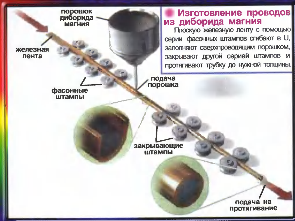
Рис. 1. Технология изготовления проводов из сверхпроводящего материала диборида магния.
