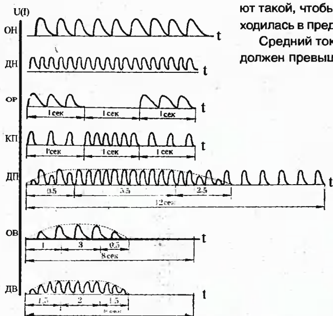
Рис. 3. Наиболее широко используемые виды динамических токов
