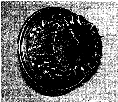
Рис. 2. Фото монтажа резисторов в корпус устройства
