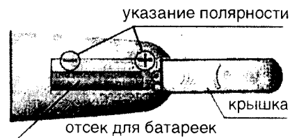
Рис. 46. Установка батареек в пульт ПДУ-10
