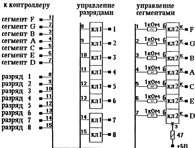
Рис. 3 ключи К1 - 2 микросхемы К155ЛП9 ключи К2 - 7 транзисторов КТ361
