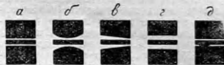
Рис. 22. Регулировка просвета: а—правильно, б, в, г, д—неправильно.
