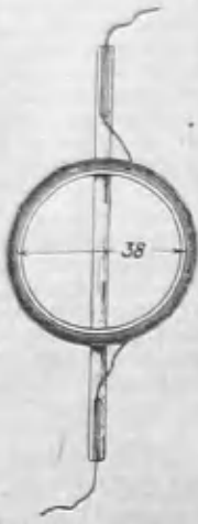
Рис. 2. Устройство катушки обратной связи L_2 .
