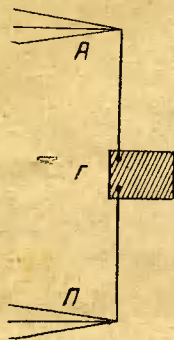
Рис. 3. Увеличение емкости системы антенна — противовес помощью сети горизонтальных проводов.
