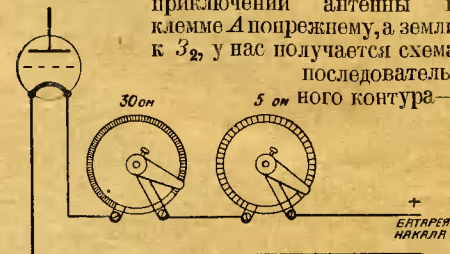
Рис. 2. Включение двух реостатов для тонкой регулировки накала.
