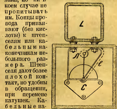
Рис. 5. Монтаж волномера по схеме рис. 2.
