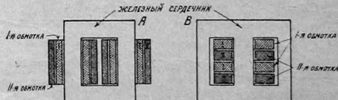
Рис. 3. А) Стержневой тип трансформатора с цилиндрическими катушками. В) Броневой тип с дисковыми катушками.
