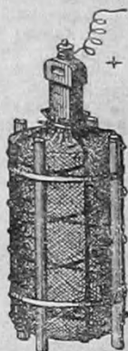
Рис. 3. Деполярирующий мешок элемента Лекланше.
