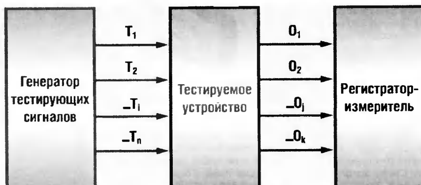
Рис. 2. Блок-схема измерения характеристик “черного ящика”
