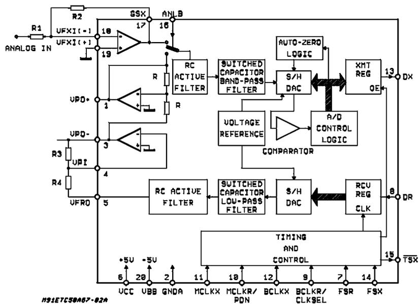
аналогового сигнала. Цифроаналоговый преобразователь (ЦАП или DAC) ETC5067D служит для обратного преобразования записанной в памяти цифровой голосовой информации в аналоговый звуковой сигнал — при воспроизведении. Ком-
