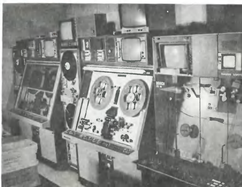
Сн. 6 — Телекино-апаратна с два киноканала по системата „бягащ лъч“ и един киноканал с ПВЗ
