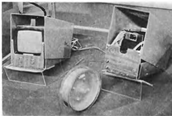
Фиг. 1. Макет на телевизионна влакно-оптическа линия за свързка, предназначена за използване в рудници и мини. Автор на конструицията С. Щур
