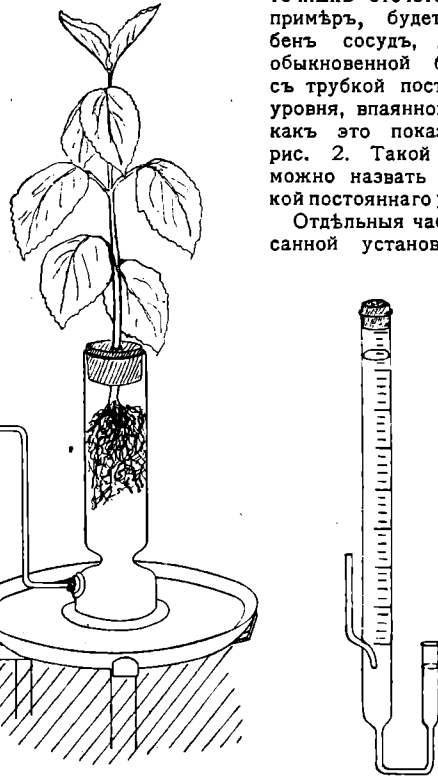
Рис. 1. Приборъ для одновременнаго опредѣленія засасыванія и испаренія воды растеніемъ.
