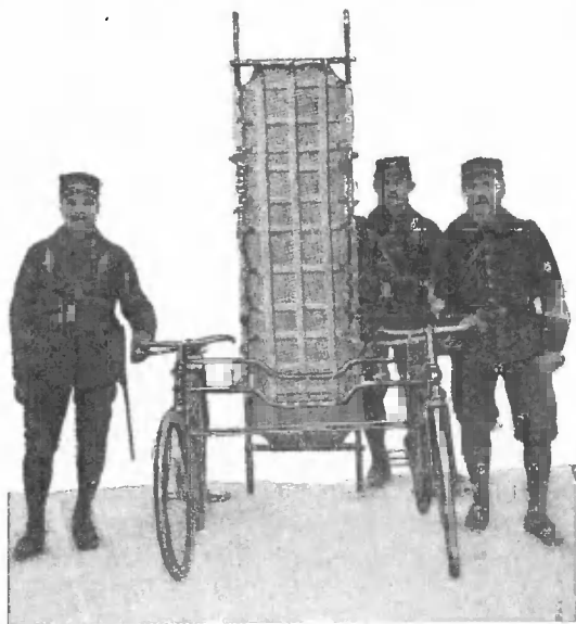
Рис. 109. Велосипеды, приспособленные для перевозки раненыхъ. Сзади носилки, укладываемыя на поперечныя тяги.
