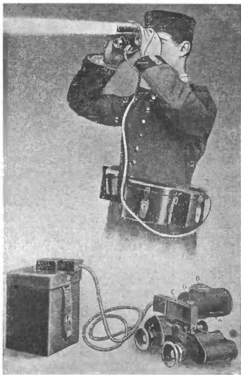
Рис. 93. Свѣтовой сигнальный аппаратъ германской арміи. А—труба, собирающая лучи въ тонкій пучокъ, В—мѣсто помѣщенія электрической лампы, С—мѣсто выключенія аккумуляторной батареи, Д—прерыватель тока, Е—призматическій бинокль.
