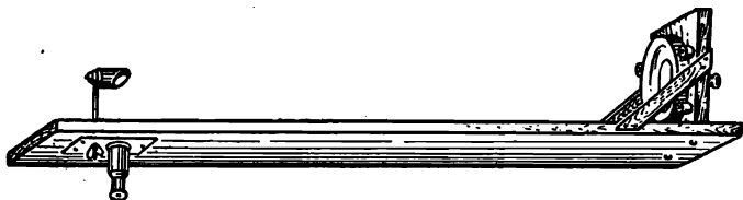
Рис. 6. «Чикинская доска» для предварительной монтировки. Описанное в тексте устройство окулярной части доски несколько упрощено по сравнению с показанным на рисунке
