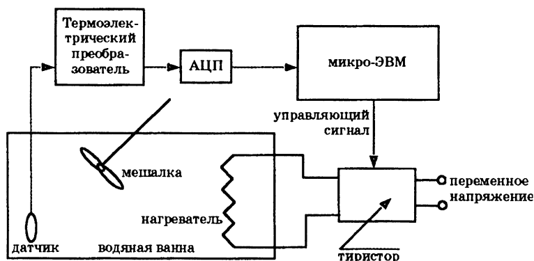
Рис. 5.2.1. Схема системы управления температурой водяной ванны
