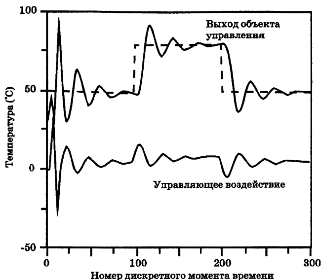
Рис. 3.4.3(a). Характеристика СМПИД-контроллера для системы с уменьшенным значением коэффициента P_{n2}
