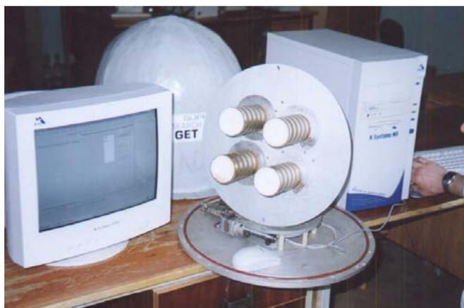
Рис. 7. Приемная антенна МСПОИ и ПЭВМ обработки данных
