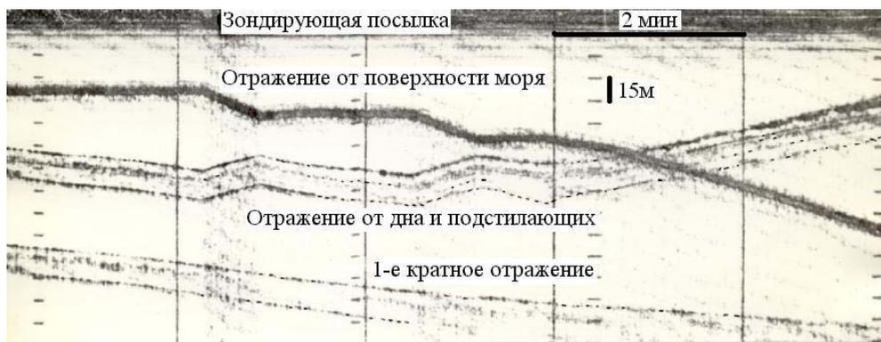
Рис. 2. Изображение разреза осадочных отложений, полученное с помощью АП «Звук-Л» в ЧМ-режиме (Черное море, Болгарский шельф)
