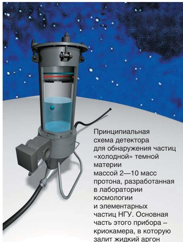
Принципиальная схема детектора для обнаружения частиц «холодной» темной материи массой 2—10 масс протона, разработанная в лаборатории космологии и элементарных частиц НГУ. Основная часть этого прибора – криокамера, в которую залит жидкий аргон
