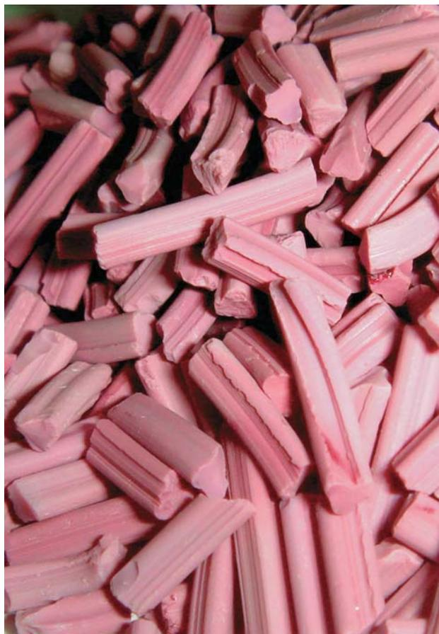
предшественника катализатора (смешанных оксидов алюминия и марганца) в результате его окисления. Тем самым в катализаторе «запасается» слабосвязанный кислород, необходимый для протекания окислительной каталитической реакции. Целенаправленное регулирование условий приготовления и активации позволило химикам получить катализаторы с разными параметрами наноструктуры и содержанием кислорода и, соответственно, с различной каталитической активностью.
