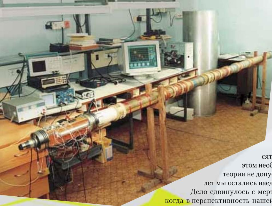
Комплекс ВИКПБ, предназначенный для каротажа в процессе бурения
