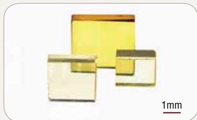
Элементы детекторов ионизирующих излучений, изготовленные из кристаллов синтетического алмаза
