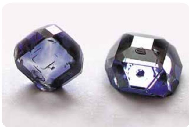
Полупроводниковые (*p*-тип проводимости) кристаллы алмаза, легированные бором
