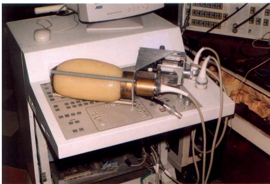
Первый проект продлился с 1998 по 2001 г., второй — с 2002 по 2004 г., третий был реализован в 2006 г. На фотографии — обойма из диагностического датчика в центре излучателя накачки, который в экспериментах с помощью силы радиационного давления формировал источник сдвиговых волн в объекте
