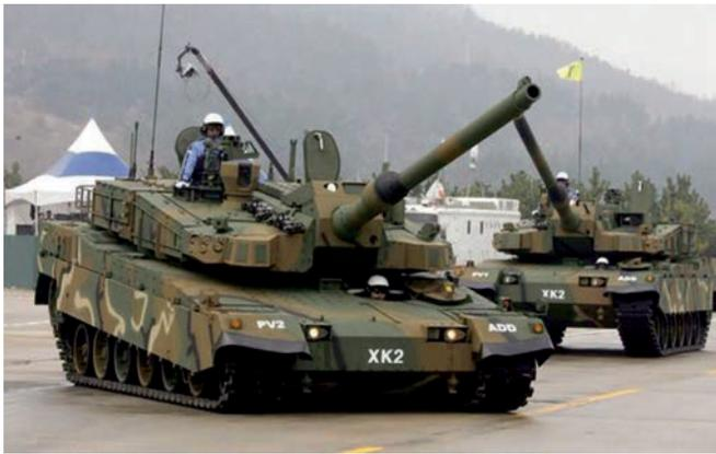
Опытные южнокорейские основные танки K2. Благодаря гидропневматической подвеске танк может «присесть»
