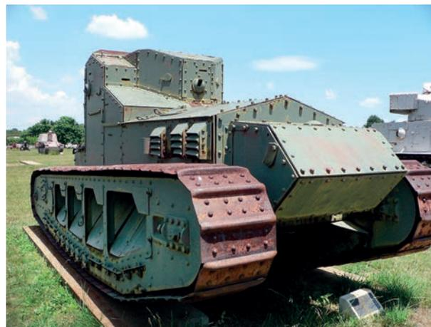
Mk A «Уиппет» внешне напоминал поставленный на гусеницы легкий броневедомитель. Силовая установка располагалась впереди, позади нее в рубке размещались экипаж и вооружение
