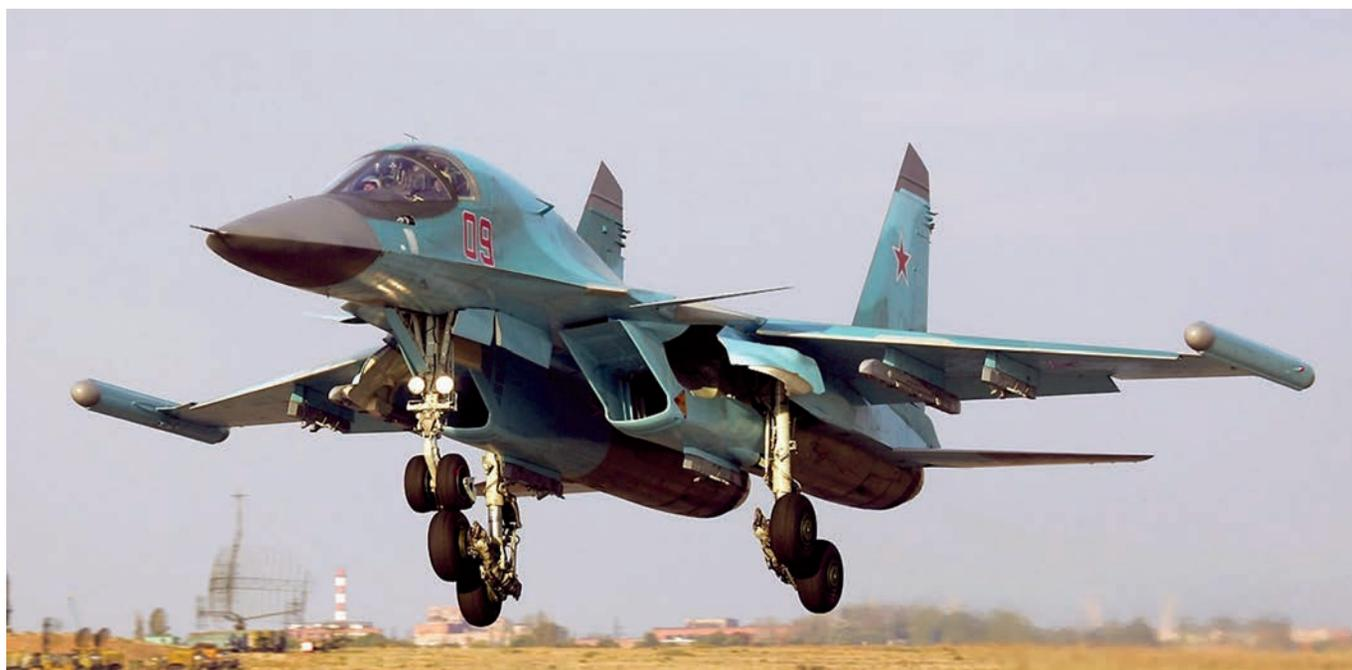
Су-34 с элементами КРЭП «Хибины» на законцовках крыльев. Фото: [airliners.net](http://airliners.net)
