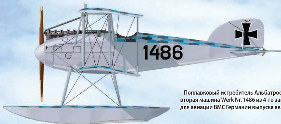
Поплавковый истребитель Альбатрос W 4 — вторая машина Werk Nr. 1486 из 4-го заказа для авиации ВМС Германии выпуска августа 1917 г.
