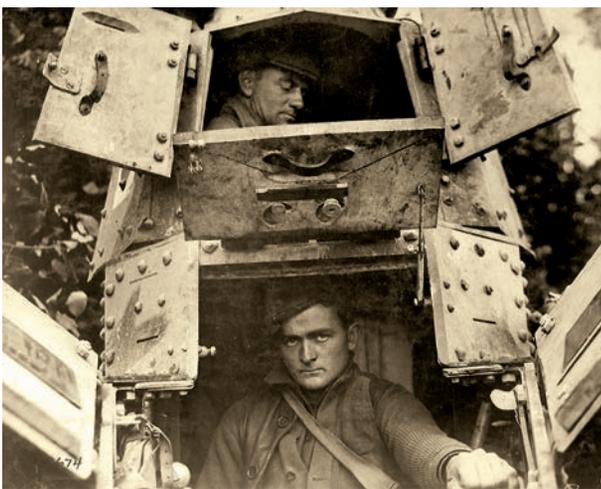
Для входа и выхода экипажа на «Рено» FT-17 был предусмотрен трехстворчатый люк в передней части корпуса и аварийный люк-лаз в задней части башни (на фото башня развернута назад)
