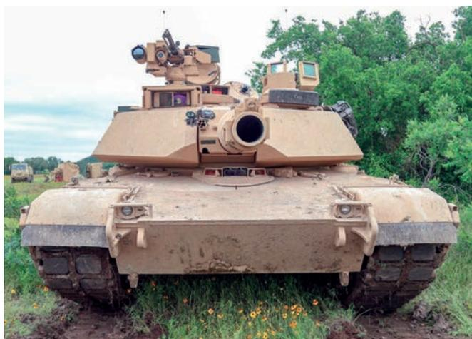
На крыше башни рядом с рабочим местом командира установлен дистанционно управляемый боевой модуль CROWS-LP с крупнокалиберным пулеметом M2HB
