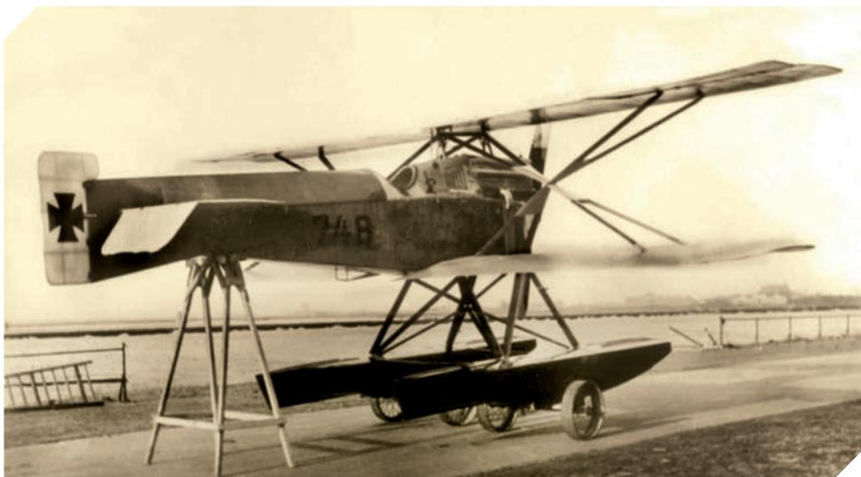
Первый опытный морской истребитель Ганза-Бранденбург KDW № 748 в том виде, в котором он поступил на испытания. Фото: <http://www.airwar.ru/enc/fww1/kdw.html>
