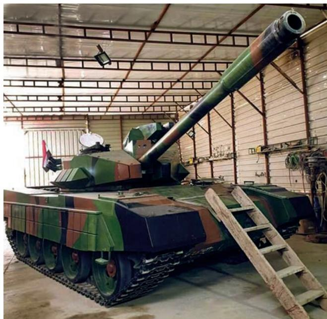
Прототип иракского танка «Кафил-1». Башня в передней части приобрела клиновидную форму, напоминающую башню израильского танка «Меркава 1»
