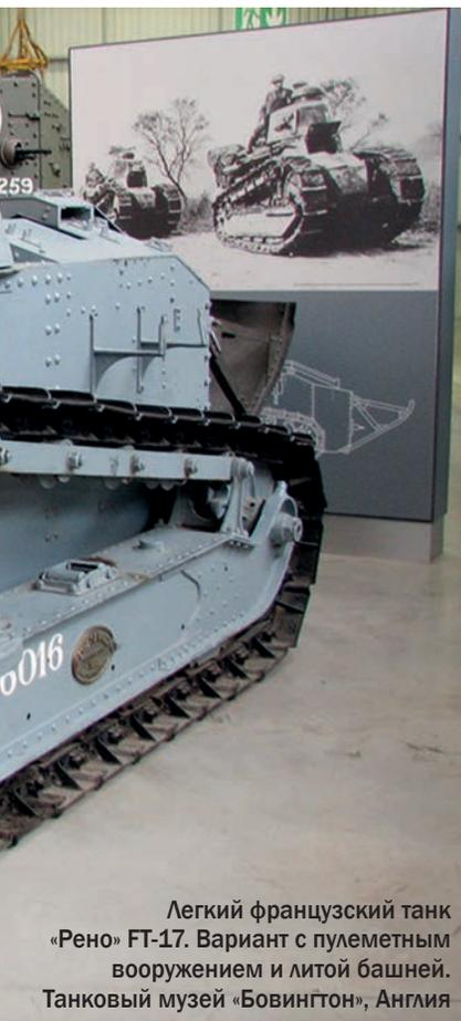
Легкий французский танк «Рено» FT-17. Вариант с пулеметным вооружением и литой башней. Танковый музей «Бовингтон», Англия
