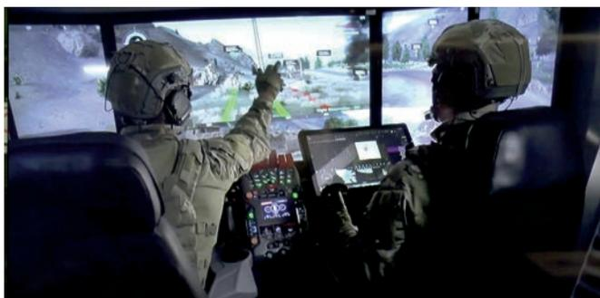
Корпус машины полностью «глухой», поэтому круговой обзор экипажу обеспечивается при помощи бортового радара и внешних камер. Кабина для двух членов экипажа оснащена большими интерактивными экранами
