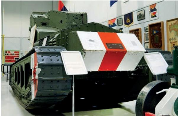
На Mk A топливный бак стоял прямо в носу корпуса. Несмотря на то, что лобовые бронелисты толщиной 14 мм устанавливались с наклоном, бак оказался весьма уязвимым от огня противника
