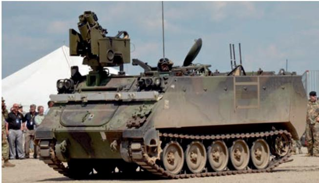
Экспериментальный RCV на базе бронетранспортера M113
