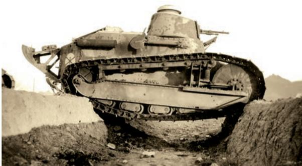
Ходовая часть FT-17 позволяла танку преодолевать довольно серьезные препятствия. Помогал в этом и съёмный хвост, за счет которого удлинялся корпус
