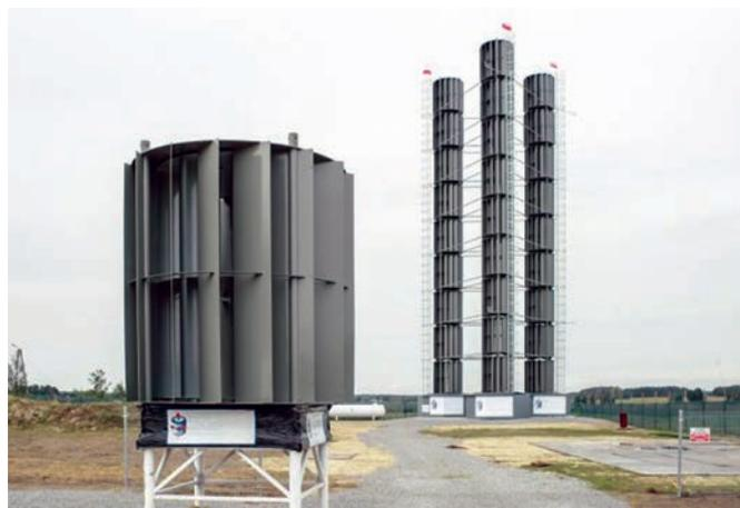
Рис. 2. Многолопастные турбины карусельного типа
