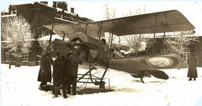
Серийный экземпляр С-16 на зимнем лыжном шасси — машина без вооружения снята, вероятно, во время приемки во дворе РБВЗ. Фото: [http://www.earlyaeroplanes.com/br.challenge/aircraft/ersatz/791\\_Sikorsky.RVBZ.S-16e.jpg](http://www.earlyaeroplanes.com/br.challenge/aircraft/ersatz/791_Sikorsky.RVBZ.S-16e.jpg)
