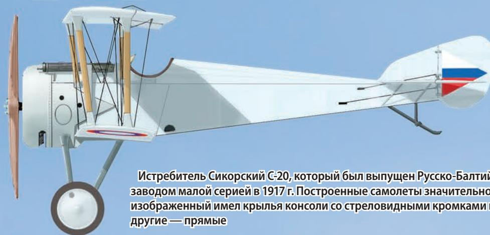
Истребитель Сикорский С-20, который был выпущен Русско-Балтийским воздухоплавательным заводом малой серией в 1917 г. Построенные самолеты значительно отличались друг от друга, изображенный имел крылья консоли со стреловидными кромками по типу «Ньюпоров», другие — прямые
