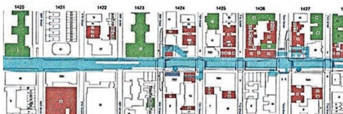
Рис. 4. Здания на 2-й авеню, уязвимые к влиянию строительства туннеля метро.
