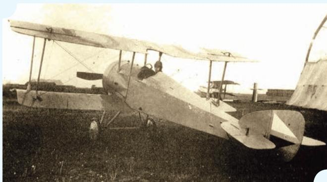
Истребитель Сикорский С-20 с прямыми крыльями и без окон в центроплане. Тросы управления рулем высоты проходят сквозь стабилизатор. Фото: <http://www.airwar.ru/enc/fww1/s20.html>
