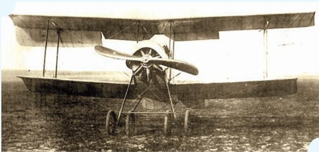
Серийный истребитель С-16 с пулеметом Викарс Mk.I по левому борту носовой части фюзеляжа и синхронизатором Лаврова. Фото: <http://www.airwar.ru/enc/fwv1/s16.html>
