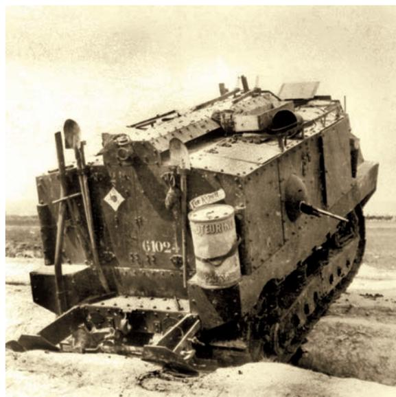
Небольшой «хвост» смонтированный сзади облегчал преодоление рвов
