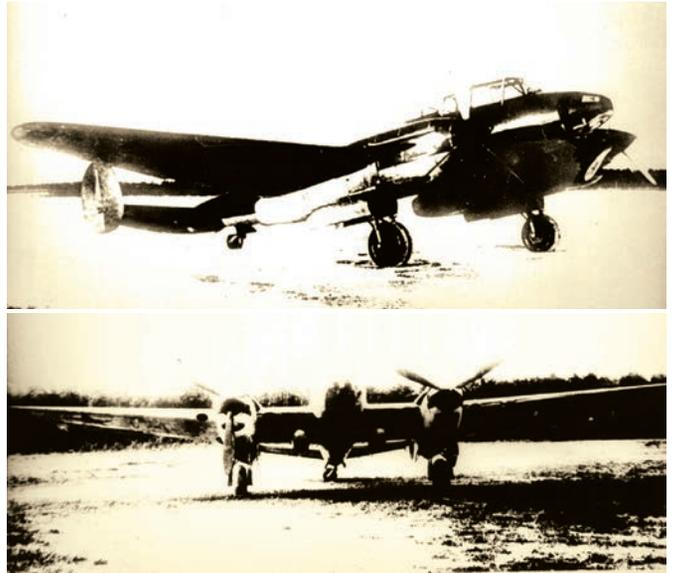
Головной экземпляр пикирующего бомбардировщика Пе-2 № 390101, построенный заводом № 39.
