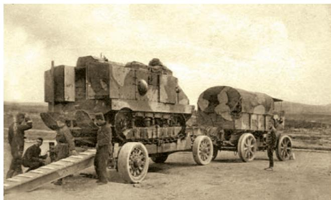
На большие расстояния танки перевозили на трейлерах
