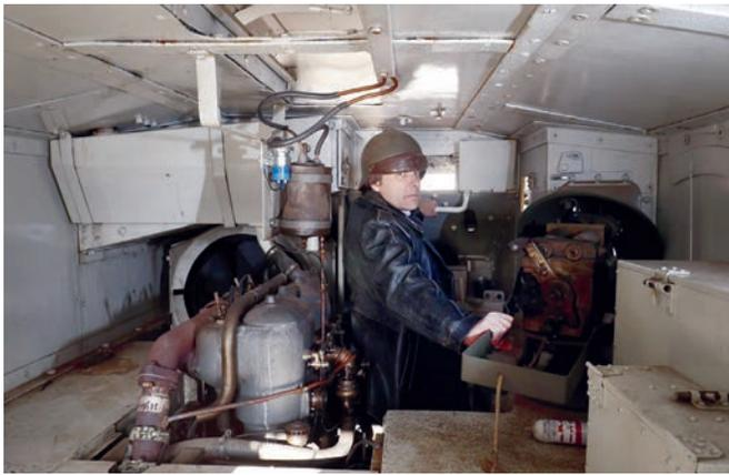
Интерьер танка «Шнейдер». Слева виден двигатель, по центру — место водителя, справа — казенная часть пушки
