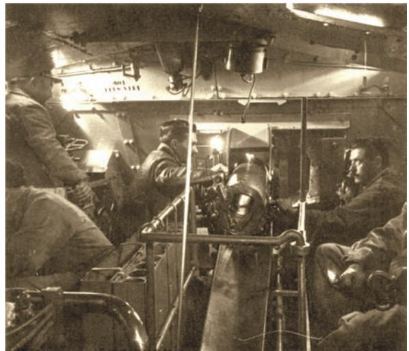
Экипаж танка «Сен Шамон», в центре видна казенная часть 75-мм пушки
