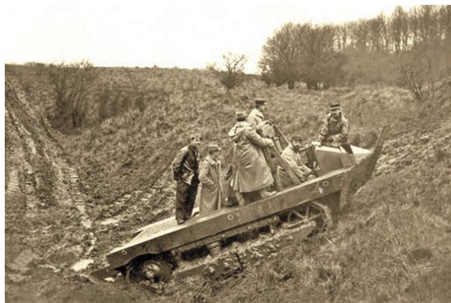
Испытания шасси танка фирмы «Шнейдер»
