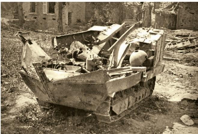
Разрушенный танк «Шнейдер», вероятно, взорвались бензобаки или боекомплект
