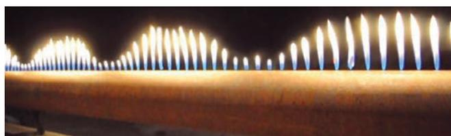
Демонстрация звуковой стоячей волны при помощи трубы Рубенса:
