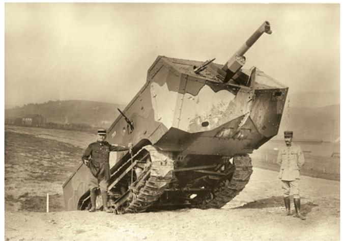
Танк «Сен Шамон», видна ходовая часть
