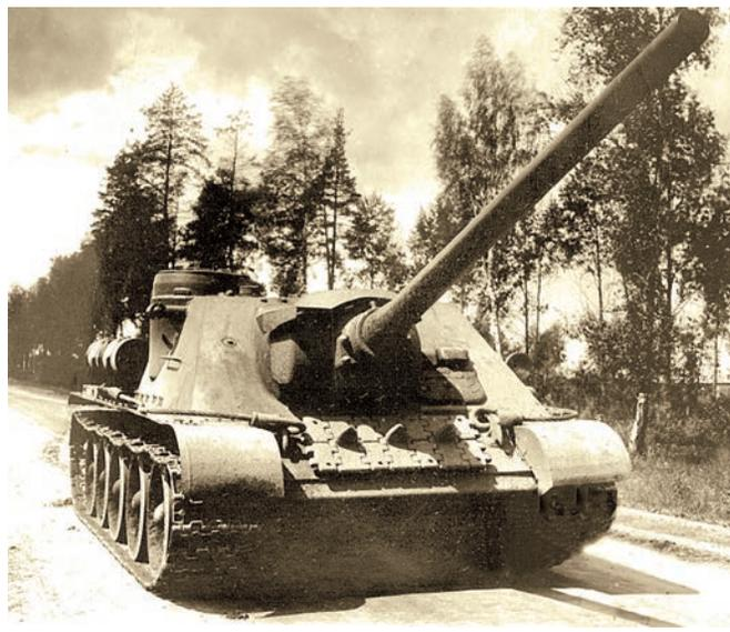
Прототип СУ-100-2 со 100-мм орудием С-34, июнь 1944 г.
