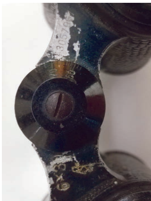
Бинокли Б-6 производства КОМЗ 1943 и 1945 гг. выпуска. Бинокли имеют стальные крышки корпуса и колпаки объективов, кроме того, бинокль 1943 г. (верхний) оснащен окулярами, у которых муфты, основания и оправа линз отлиты из цинкового сплава, а верхний и нижний диски на шарнире изготовлены из карболита
