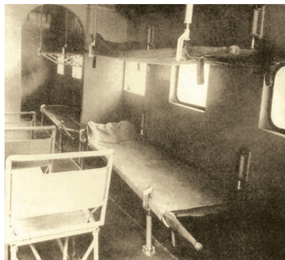
Размещение санитарного оборудования в транспортно-санитарном самолете Potez 650
