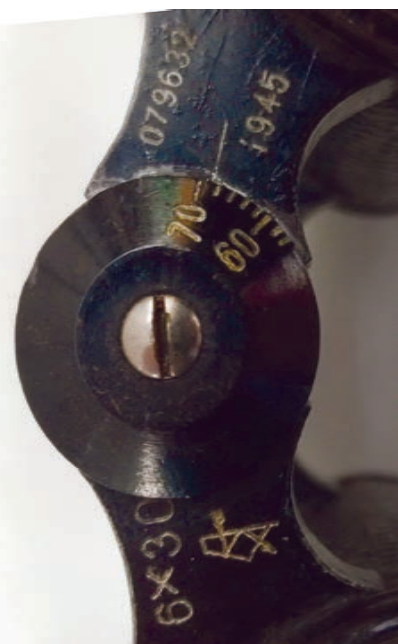
Бинокли Б-6 производства КОМЗ 1943 и 1945 гг. выпуска. Бинокли имеют стальные крышки корпуса и колпаки объективов, кроме того, бинокль 1943 г. (верхний) оснащен окулярами, у которых муфты, основания и оправа линз отлиты из цинкового сплава, а верхний и нижний диски на шарнире изготовлены из карболита
