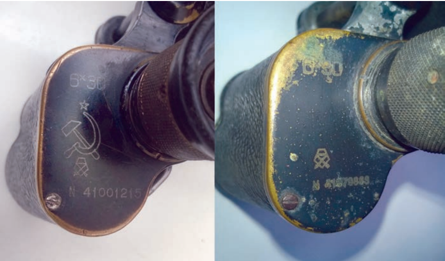
Бинокли Б-6 ГОМЗ, произведенные в начале и конце 1941 г. У бинокля выпуска конца 1941 г. № 41079883 передние крышки корпуса изготовлены из цинкового сплава
