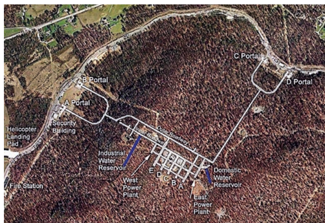
Рис. 1. Совмещенная схема поверхности и подземной части комплекса Равен Рок:
