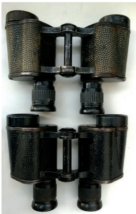
Бинокли Б-6 производства КОМЗ 1943 и 1945 гг. выпуска. Бинокли имеют стальные крышки корпуса и колпаки объективов, кроме того, бинокль 1943 г. (верхний) оснащен окулярами, у которых муфты, основания и оправа линз отлиты из цинкового сплава, а верхний и нижний диски на шарнире изготовлены из карболита
