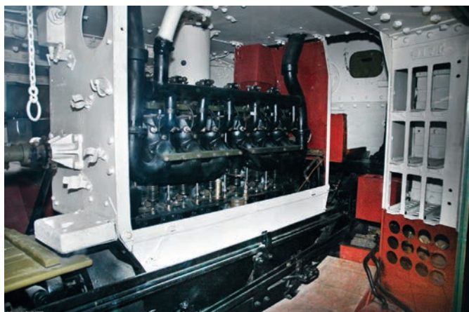
Размещение мотора в танке Mk V (вид внутрь корпуса через снятый пилон)
