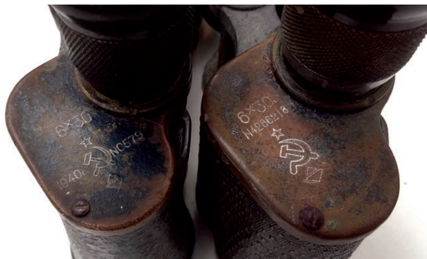
Бинокли Б-6 завода № 353 производства 1940 и 1942 гг. У бинокля 1942 г. выпуска (нижний) обоймы объективов и диоптрийные кольца изготовлены из алюминиевого сплава
