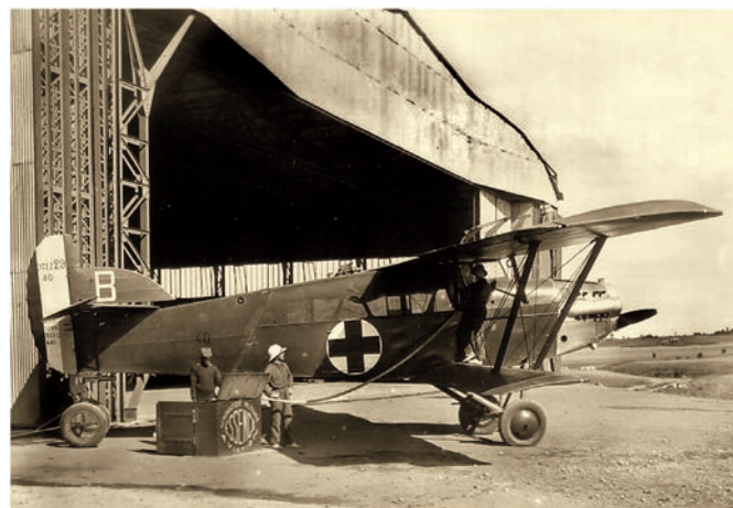
Техническое обслуживание санитарного самолета Potez 29/2
