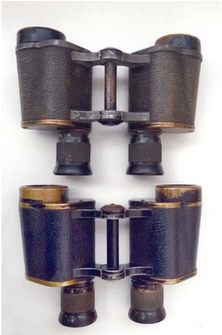
Бинокли Б-6 ГОМЗ, произведенные в начале и конце 1941 г. У бинокля выпуска конца 1941 г. № 41079883 передние крышки корпуса изготовлены из цинкового сплава
