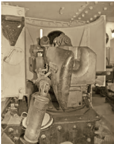
Вид изнутри на левый спонсон с 57-мм пушкой танка MkV
