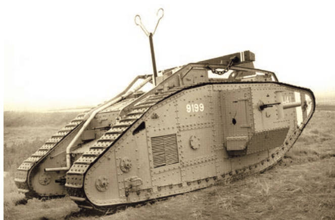
Танк MkV, на крыше хорошо видна стойка «семафора» для подачи сигналов другим танкам
