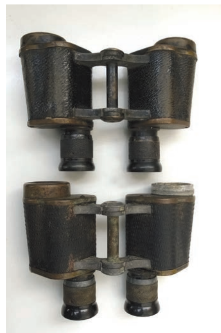
Бинокли Б-6 завода № 353 производства 1940 и 1942 гг. У бинокля 1942 г. выпуска (нижний) обоймы объективов и диоптрийные кольца изготовлены из алюминиевого сплава
