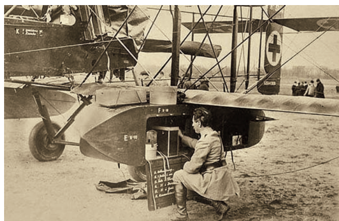
Для размещения медоборудования и раненых под нижним крылом самолета Aerochir устанавливались два специализированных контейнера
