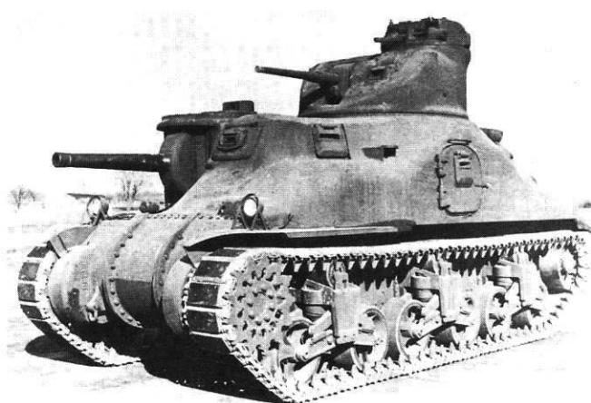
**Средний танк М3 с литым корпусом**
