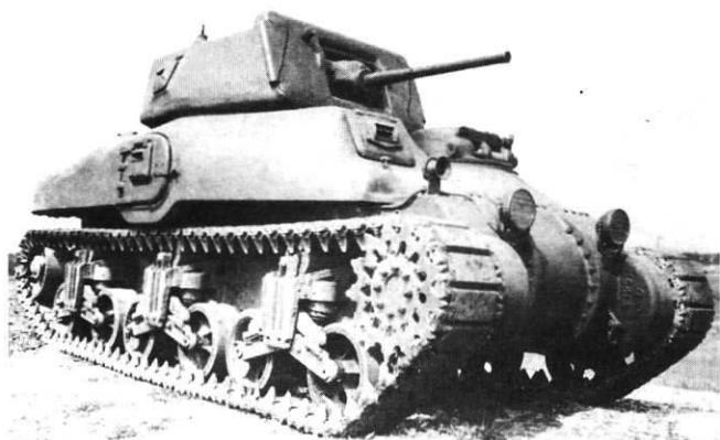
**Канадский танк RAM, выполненный на базе М-3**
