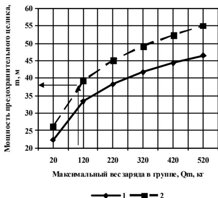
Рис.3 Графики изменения мощности предохранительного целика ( m ) от максимального веса заряда в группе ( Q_m ), рассчитанные по формуле: 1 – проф. В.Н.Мосинца; 2 – предлагаемой автором (12)
