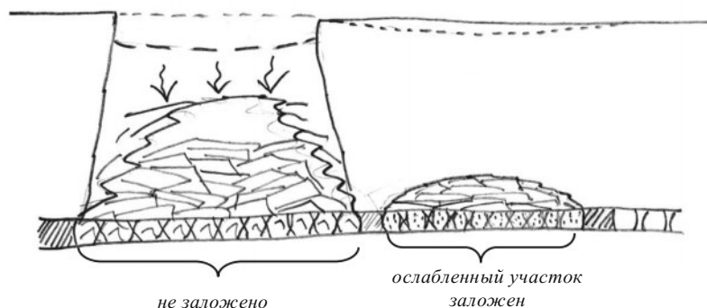
Рис. 2. Развитие обрушения до поверхности на незаложенных участках и затухание в толще пород на заложенных участках
