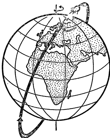
Рис. 162. Схема орбиты искусственного спутника Земли, движущегося в плоскости, угол наклона которой к плоскости земного экватора i = 65^\circ
