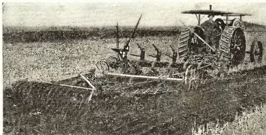
Трактор, совершающий сразу три работы: пашет, боронует и прокатывает
