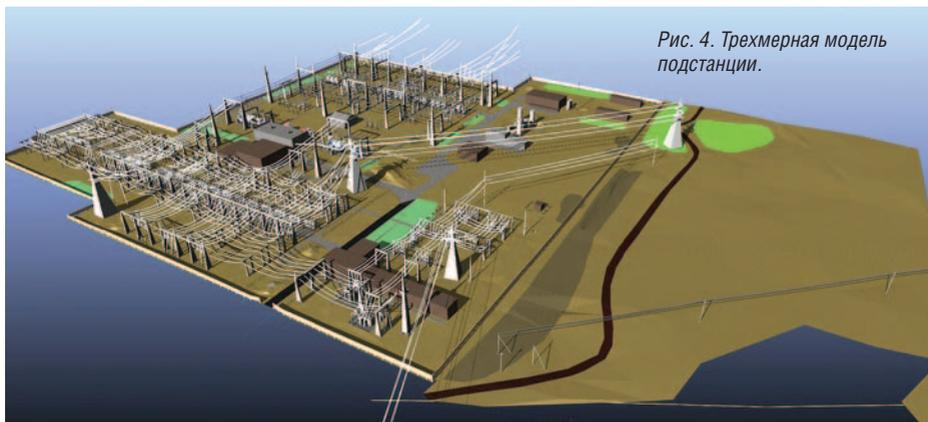
Рис. 4. Трехмерная модель подстанции.
