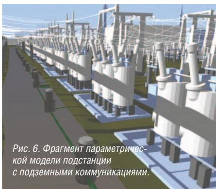
Рис. 6. Фрагмент параметрической модели подстанции с подземными коммуникациями.
