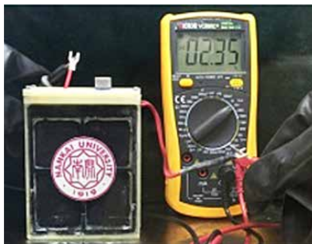
▲ Так выглядит содовая батарейка, которую в Нанкинском университете создал Сунь Цзяньчао и его коллеги из группы профессора Чэнь Цзюня («Research», 2018)
