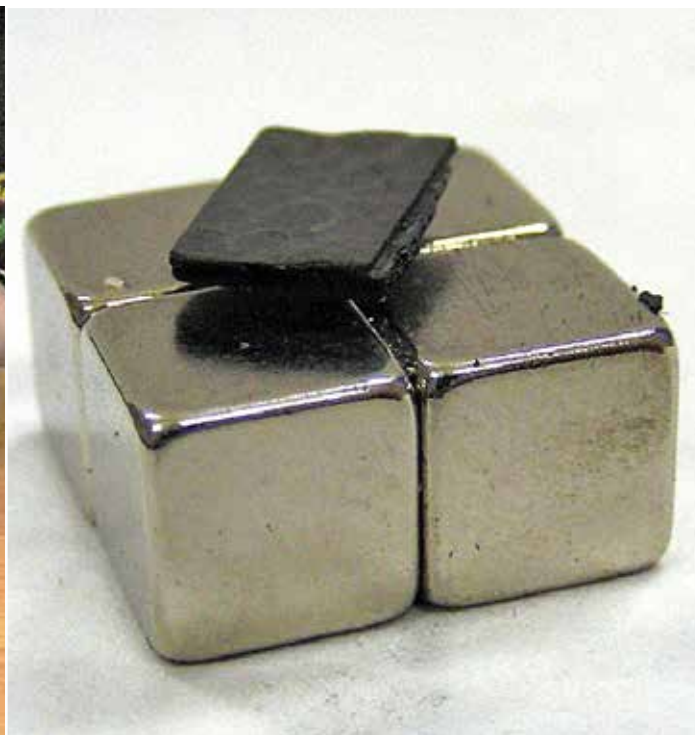
▲ Левитация монокристалла графита в магнитном поле — неустойчивая в поле диполя, устойчивая в поле четырех диполей
