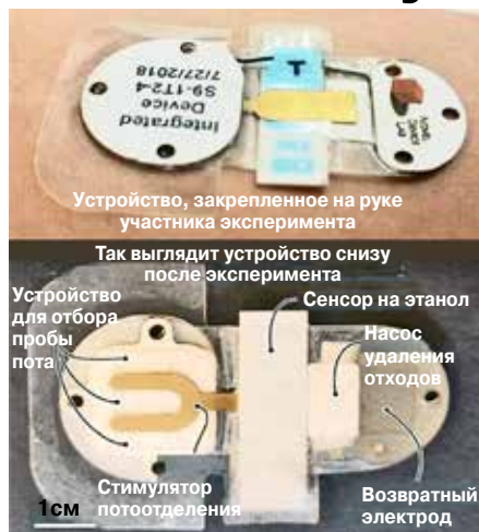
С помощью ионофореза устройство стимулирует потоотделение, когда это нужно для анализа, после чего направляет образец пота на сенсор этанола
