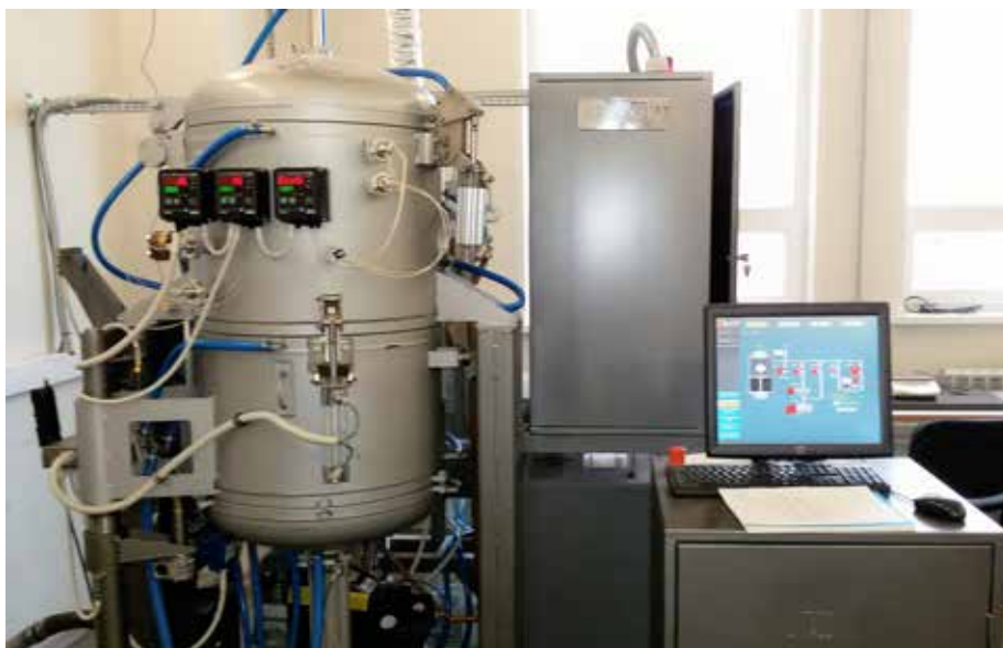
2 Установка для вакуум-термической очистки индия в Гиредмете
