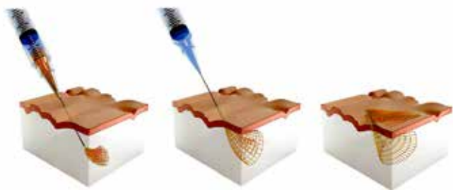
Электросхема, которую можно ввести шприцем Nature Nanotechnology, 2015, 10, 629—636
