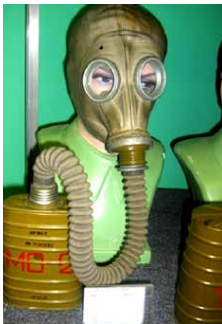
Противогаз МО-2, в котором впервые был использован для защиты от аэрозолей фильтрующий материал Петрянова. Принят на вооружение в 1942 году
