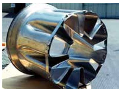
Разноцветные пленки анодированного ниобия пригодились ювелирам, а жаропрочный сплав с ниобием пошел на изготовление деталей авиадвигателей (с. 22)
