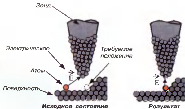
3 Перемещение атомов с помощью зонда
