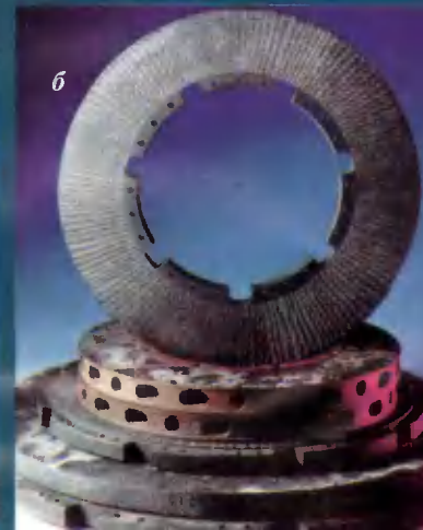
6 Углерод-углеродные материалы а — это сопло для двигателя американской ракеты сделали французские инженеры б — тормозные колодки для самолетов и поездов
